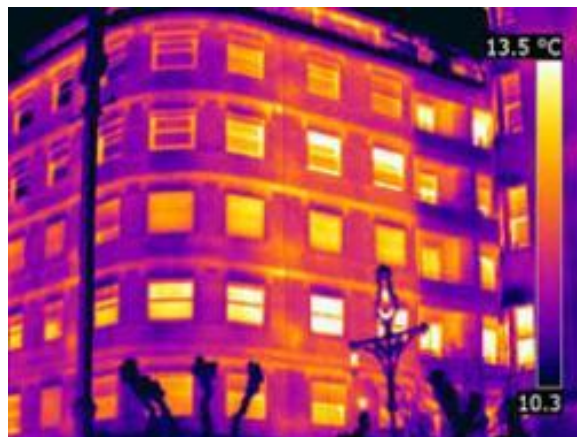
Ilustración 14. Imágenes de las pérdidas energéticas a través de los huecos.
