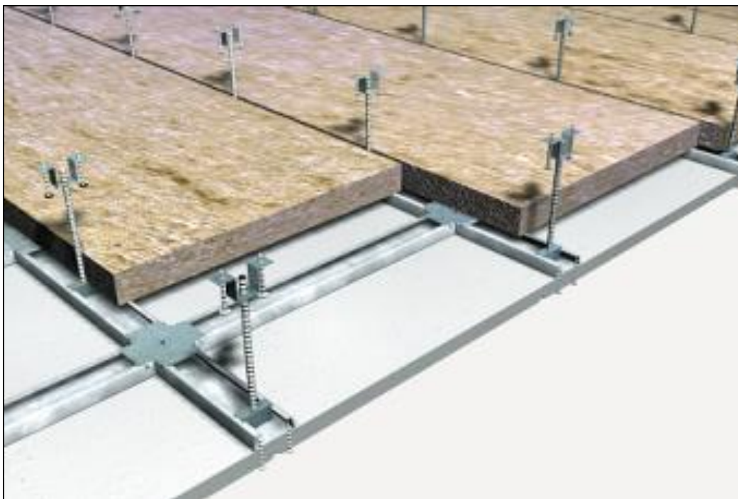
Ilustración 18. Falso techo con aislamiento.
