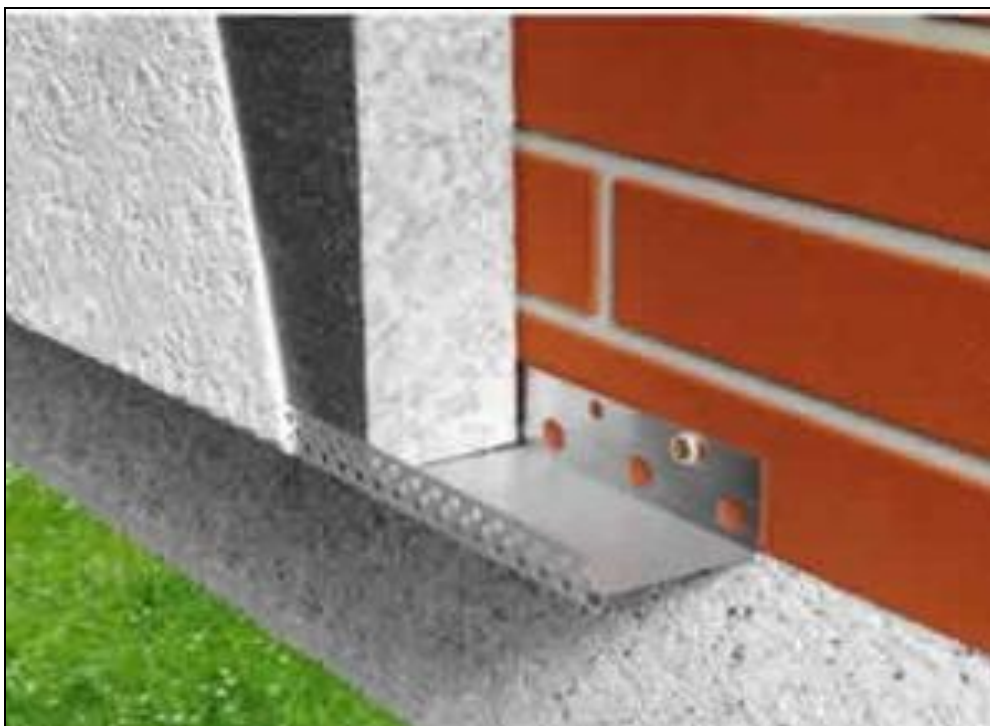
Ilustración 16. Sección de la composición del sistema SATE.
